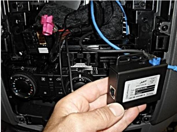
ImageHub an Steuergerät mit Originalkabel anstecken.
