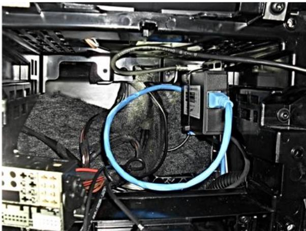
ImageHub an Kabel zum Radio Audio 15 anstecken.
