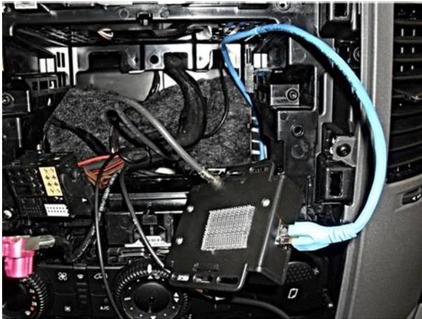
ImageCutter mit ImageHub über RJ45-Kabel verbinden.
