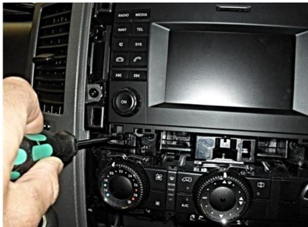
4 x Schrauben für Radio Audio 15 lösen
