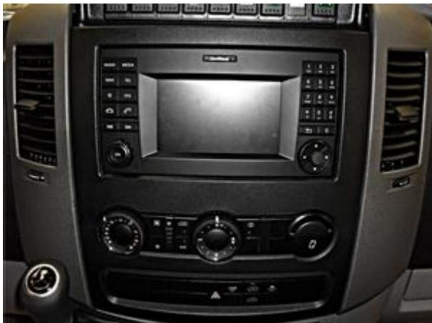
Die Frontblende um das Radio Audio 15 herum entfernen und die gesamte Radio Audio 15 Einheit ausbauen.
