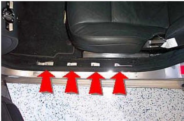
Die Einstiegsleiste muss entfernt werden. Dazu muss sie abgezogen werden; die Kraft soll nur an den Stellen der vier Rastlöcher angesetzt werden. **Achtung:** Gefahr der Zerstörung der Einstiegsleiste.
