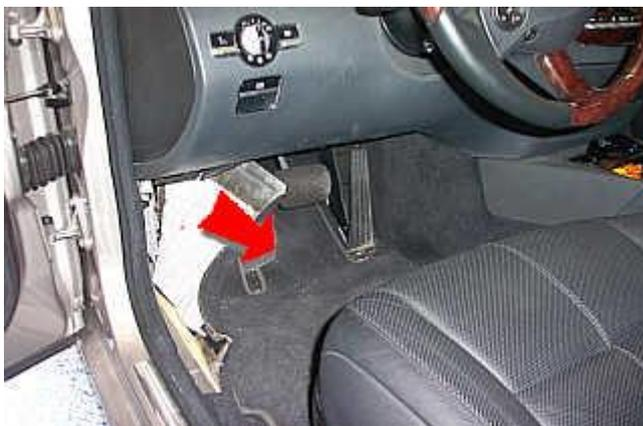
Die seitliche Verkleidung kann jetzt nach rechts weggeklappt werden. Dazu ist etwas Kraft erforderlich.
