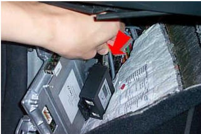
... der ImageHub eingesetzt und der Stecker auf der Seite mit der Beschriftung "To Display" eingesteckt werden.
