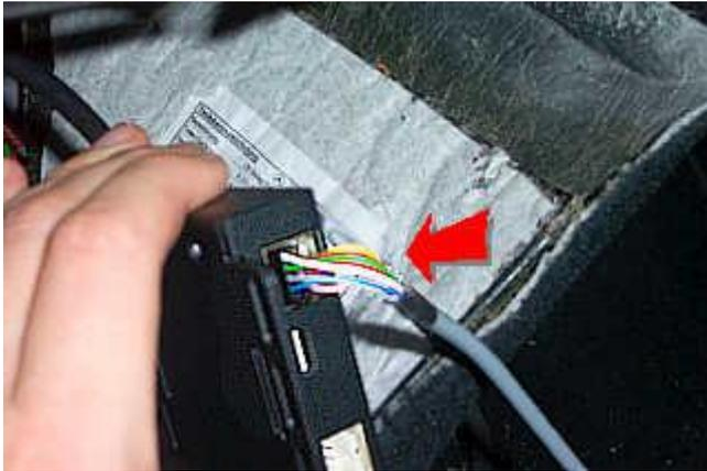
Das 1:1-Kabel mit dem Ende mit dem schmalen Stecker in den ImageHub in die Buchse mit der Bezeichnung "From Control Unit1" stecken. Weiße Ader oben links. Eventuell muss die Codierungsnase des schwarzen Steckers am 1:1-Kabel etwas abgewickelt werden.
