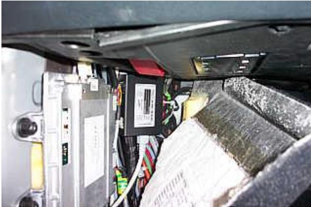
Den ImageHub hinter dem Steuergerät verstauen und das Patch-Kabel einstecken. Das Patch-Kabel kann jetzt nach Belieben zum ImageCutter30 verlegt werden. Jetzt die Verkleidungen wieder anbringen.
